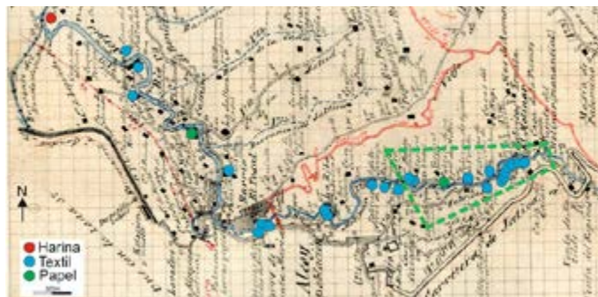
Figura 7. Sección del río Molinar (hasta el casco urbano de Alcoy) y del río Serpis (desde el casco urbano), con las instalaciones fabriles funcionales en 1898: molinos de harina, batanes de textil y de papel. La línea discontinua indica el espacio protegido como BIC (2005). Fuente: Instituto Cartográfico Nacional de España, Minuta , elab. prop.
