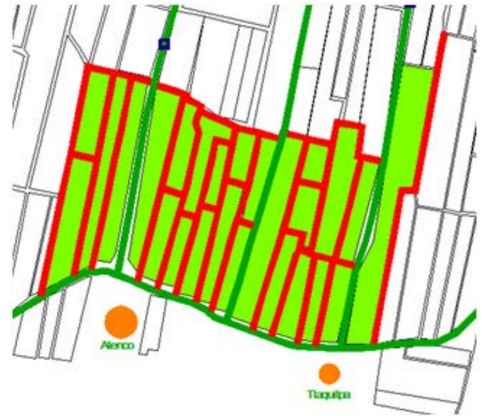
Figura 9. Proyecto de restauración de 25 chinamperas entre los parajes de Atenco y Tlacuilpa, San Gregorio Atlapulco, mediante la reexcavación de 15 apantles cegados norte-sur y 12 tramos cortos oriente-poniente.
