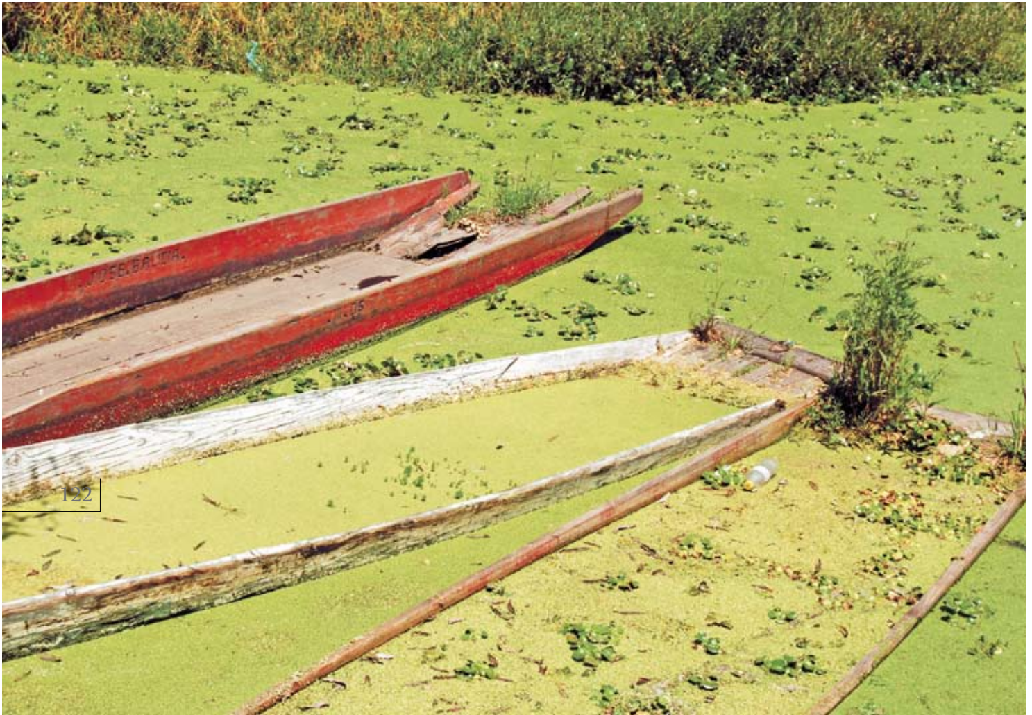
FIGURA 23. Canoas anegadas en Canal Nacional. Muchas se dejan así temporalmente para mantener la madera saturada de agua y evitar que se abran las juntas. Si se requieren, se rehabilitan con facilidad.
